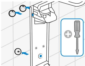
Mit Unterlegscheibe und Mutter den Spender am unteren Befestigungsadapter festschrauben.
