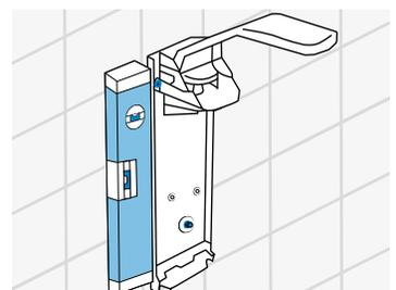
Spender wieder abnehmen: Dafür zuerst die Mutter unten komplett entfernen und Schrauben an den oberen Befestigungsadaptern mit einer Umdrehung lösen. Den Spender aushängen.
